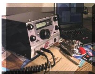
Pronto va a estar en el Sitio del RCU [WWW.CX1AA.ORG](http://WWW.CX1AA.ORG) la descripción completa del **Transceiver RCU 75** para SSB, CW y Modos digitales.
